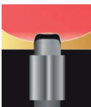
Ripetere l'operazione millimetro per millimetro. per 5 volte, fino ad ottenere un sollevamento totale della membrana di 5 mm.
